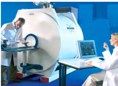
■ マイクロイメージングを可能にする高磁場MRI 臨床用MRIよりも数倍高い7テスラの強い磁場を持ち、高い分解能で生体内を生きたまま観察できます。[MRIに写る薬]を開発し、薬が病気に効いているかを判断できます。
