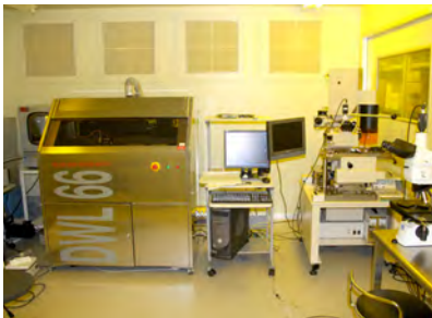
■ ナノ診断デバイス試作用クリーンルームとリソグラフィー装置 コンピューター上で作成した微細構造体の寸法データに基づいて、 \mu\text{m} 以下の高精度で光感応性樹脂を成形する装置です。ナノ診断デバイスの試作に用いられます。
