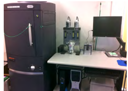
■ 発光および蛍光 in vivo イメージングシステム ルシフェラーゼを発現する癌細胞の増殖を光の強度として定量し、癌細胞の同所移植モデルや転移モデルに対するナノデバイスの治療効果の判定が可能です。また、ナノデバイスに搭載する遺伝子やタンパク質を蛍光標識することによって、生体内におけるそれらの分布を非侵襲的に観察します。
