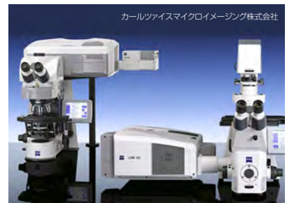
■ 共焦点顕微鏡 LSM 780 ナノデバイスの細胞内分布と挙動を高時間空間分解能で解析するために利用されます。
