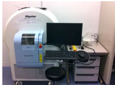
■ 高分解能を実現した動物用CT 疾患動物モデルに対するナノデバイスの治療効果を非侵襲的イメージングにより評価することが可能です。また骨解析および脂肪計測により研究に必要な定量的情報が精度良く得られるようになります。
